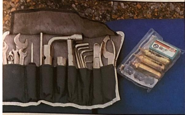
Un taller bajo el asiento. Inmejorable dotación de herramientas de muy buena calidad y kit de reparación para los neumáticos tubeless de las dos GS.
